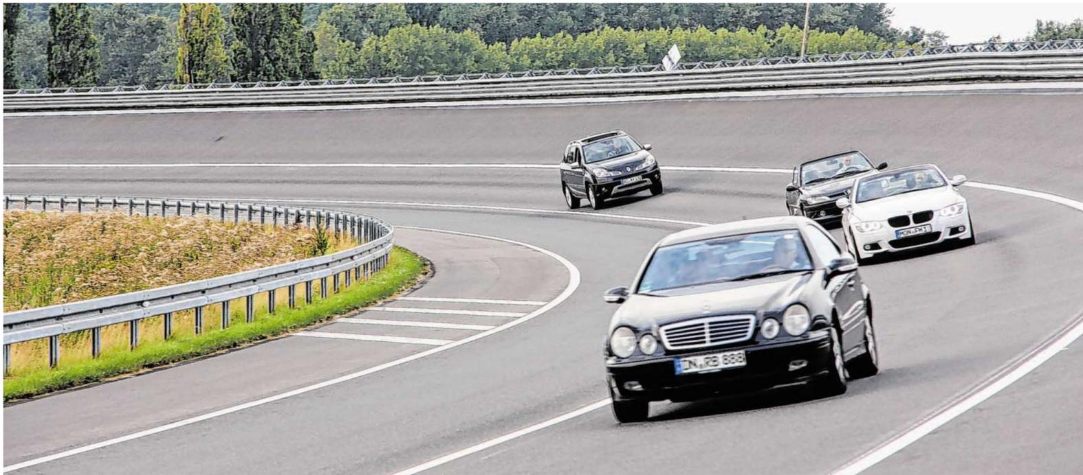
Es geht noch steiler: Zum Warmwerden führen die Teilnehmer zunächst über die mittlere Spur. Später machten sie dann die Erfahrung, dass sie beim Durchfahren der Kurve auf der äußeren Spur das Lenkrad bei einer Geschwindigkeit von knapp 120 km/h gerade halten können und trotzdem eine Kurve fahren. Fotos: Guido Jansen
