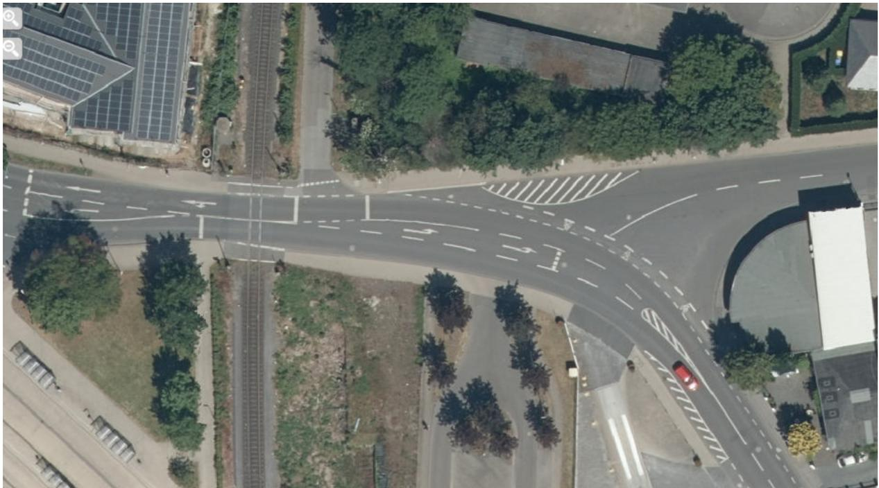
Abbildung 108: Komplexe Knotenpunktsituation mit Engstelle am Bahnübergang, P&R-Parkplatz, Industriewaage
