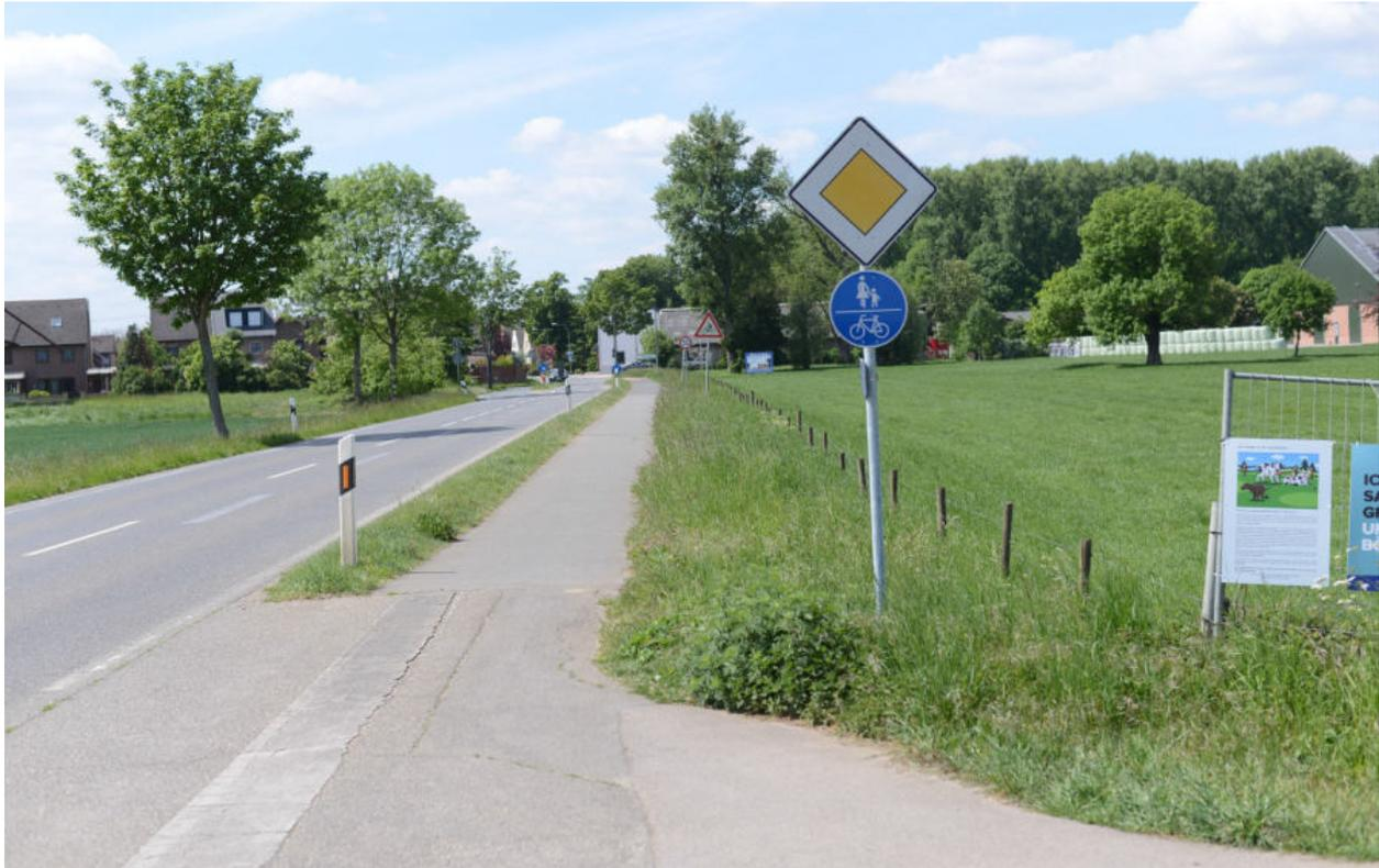
Abbildung 77: Mit einer Breite von <2,00 m entspricht der Weg nicht den Richtlinien
