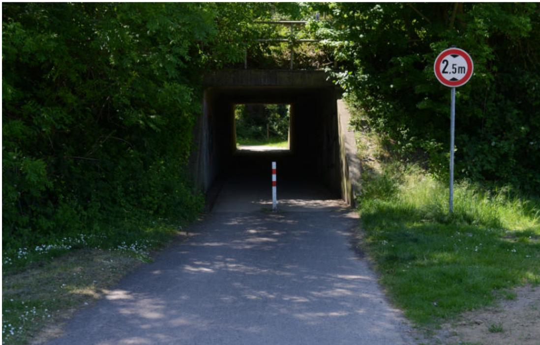
Abbildung 101: Die Unterführung stellt einen Bereich der subjektiven Unsicherheit dar. Die Verkehrssicherheit ist aufgrund der Sichtverhältnisse ebenfalls nicht gewährleistet
