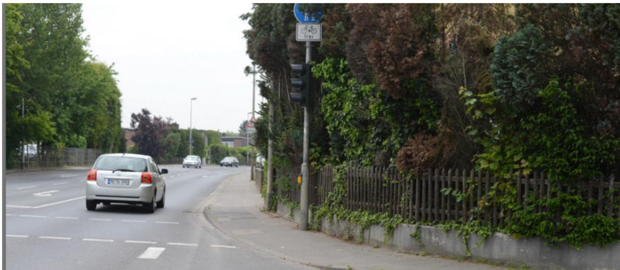
Abbildung 61 und Abbildung 62: Im Bereich des Knotenpunktes Lohfeldstraße / Ulmenweg sind die für den Radverkehr freigegebenen Gehwege ca. 1,50 m breit. Dieses Maß ist unzureichend
