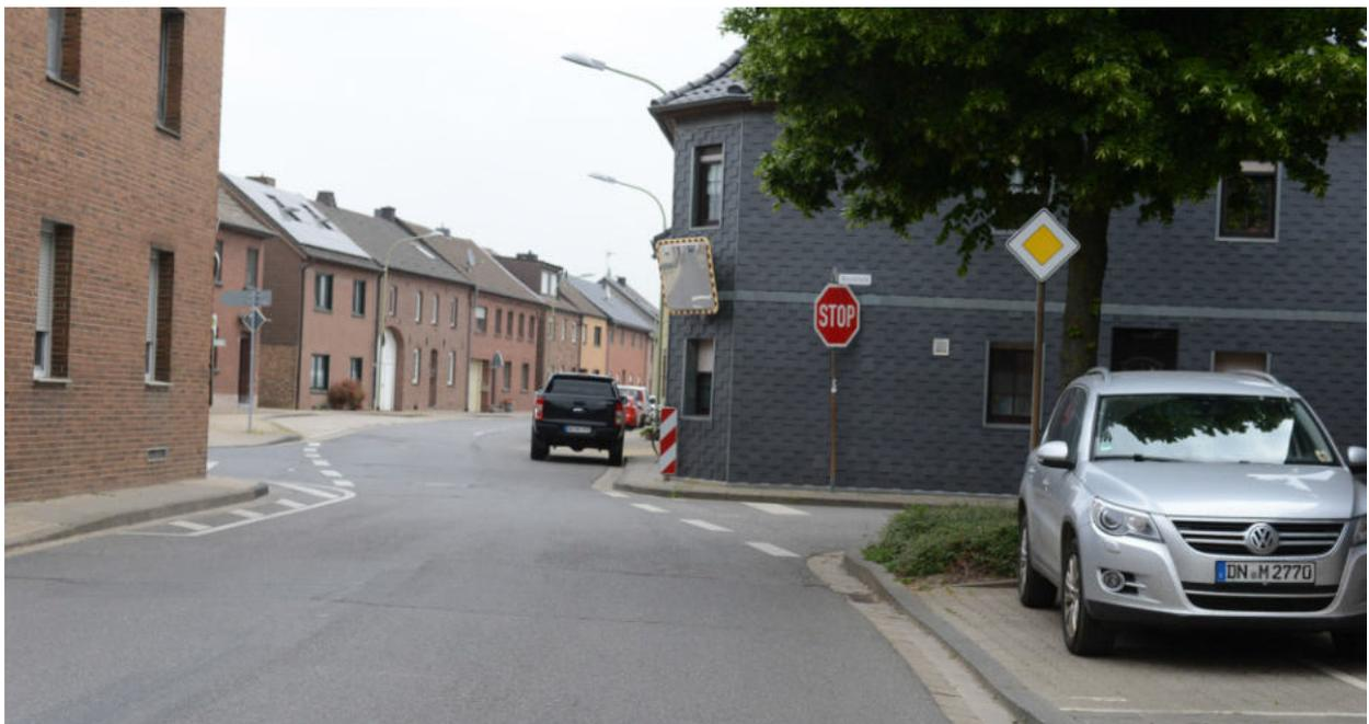
Abbildung 52: Engstelle im Straßenraum in der Welldorfer Straße (kein Schutzstreifen möglich, alternativ Absenken der zul. Höchstgeschwindigkeit?)
