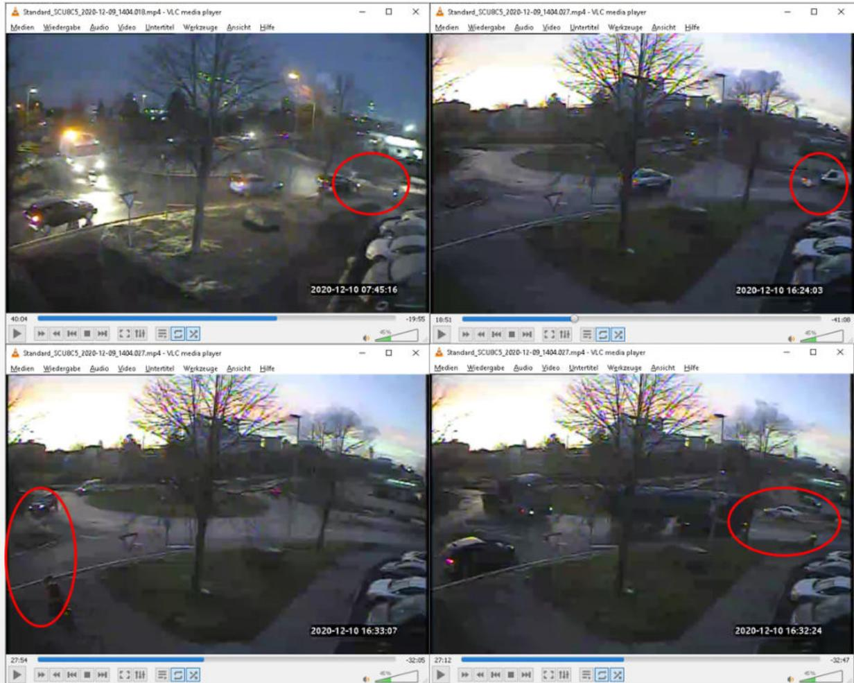
Abbildung 87: Verkehrsbeobachtungen am Kreisverkehrsplatz haben gezeigt, dass in allen Fällen die Kfz-Fahrer\*innen entgegen der gültigen Vorfahrtregelung warten und dem Radverkehr Vorrang gewähren
