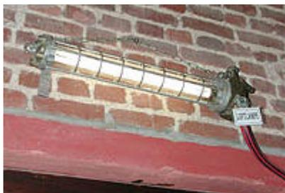
Unter Tage gab es nicht nur Licht aus Strom, sondern auch aus Luft. Wo keine Frischwetter hinkamen, benutzte man Luftlampen. Höchst interessant, und doch im Prinzip so einfach: Durch kilometerlange Leitungen wurde Luft von über Tage zur Lampe gepreßt. Direkt an ihr befand sich ein Dynamo, der wie bei einem Fahrrad die nötige Energie erzeugte.
